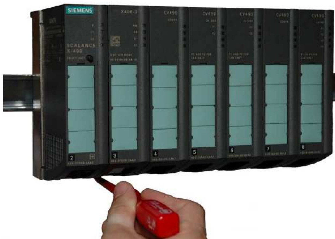
Rysunek 2-4 Usunięcie SCALANCE X408-2 z szyny DIN 35mm.
