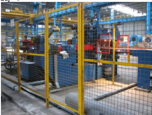
Rys. 1 Ogródzenie ochronne wokół maszyny
