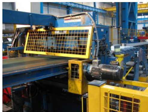
Rys. 6 Osłona noży tnących
