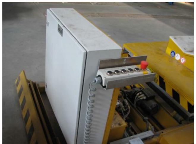
Rys. 15 Stacja sterowania lokalnego wózkem
