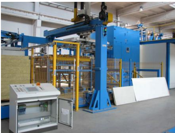
Rys. 14 Pulpit sterowania lokalnego (z AW) z panelem TP 270
