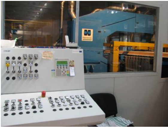
Rys. 4 Sekcja wej ciowa – pulpit nadzoru pily tn cej
