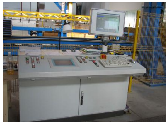
Rys. 9 Pulpit do nadzoru sekcji układania płyt
