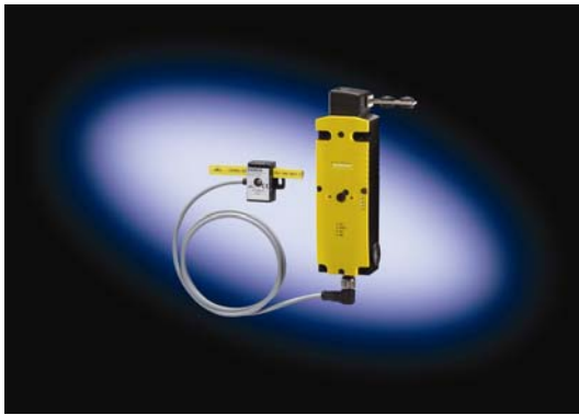
Rys2. Dzięki pełnej integracji podzespołów elektronicznych do podłączenia z interfejsem AS można podłączyć wyłączniki pozycyjne o podwyższonym standardzie bezpieczeństwa bez aparatów pośrednich bądź adapterów do żółtego przewodu AS-i
