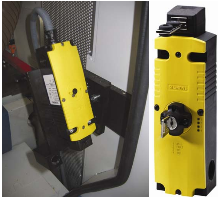
Rys. 3 Nowe wyłączniki pozycyjne z zastawką i oddzielnym aktywatorem gwarantują siłę zastawki do 2600 N. Wysoki stopień elastyczności możliwy jest do osiągnięcia przez to, że głowica może się obracać 4 x 90 stopni i dlatego, że możliwe jest czołowe wsunięcie blokady.
